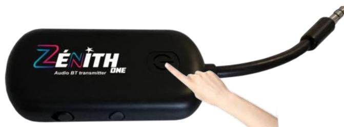
Lorsque le module Bluetooth est sous tension, sa LED clignote aléatoirement dans l'attente de l'appairage.
