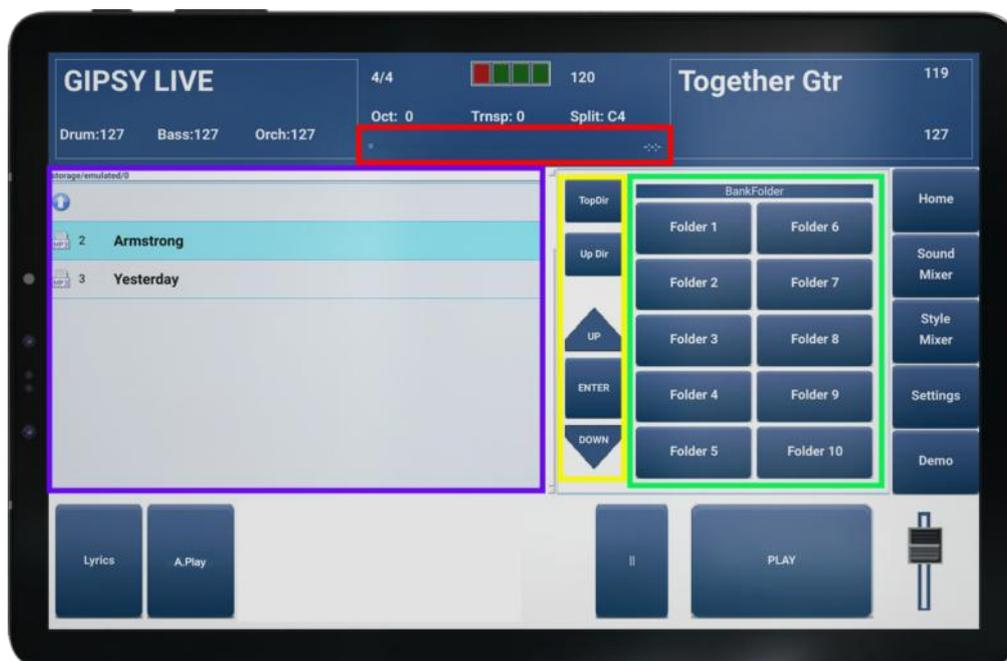
**Cadre rouge** : Chronomètre et indication en minute et seconde de la durée du MP3 / Midifile.
